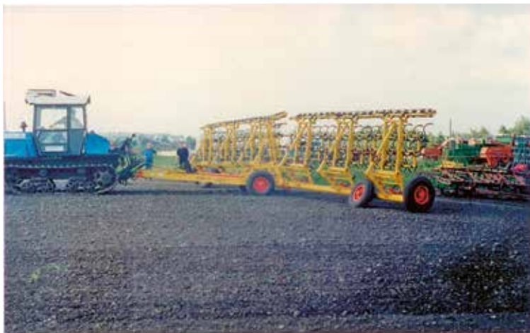
Рис. 6. Кратно высококонкурентоспособный Татарстанский культиватор блочно-модульный КБМ-14,5 в агрегате с Волгоградским трактором тягового класса 3 ВТ-100. Таких агрегатов в мире нет. (Мощность — 100 л.с., ширина захвата — 14,5 м, у западных аналогов потребная мощность — 400 л.с.)
