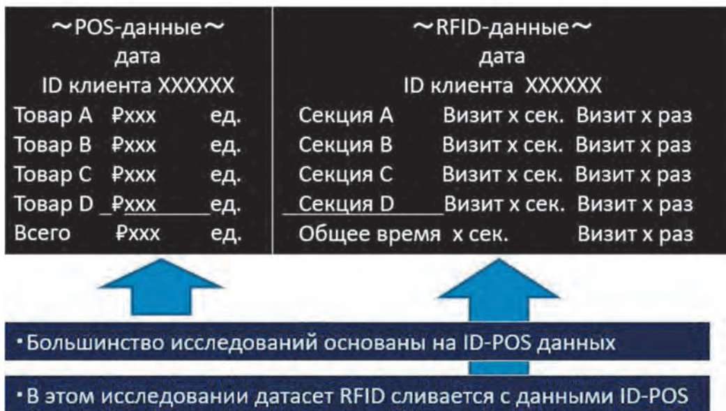
Рис. 3. Архитектура POS и RFID данных при слиянии их потоков через общий идентификатор клиента
